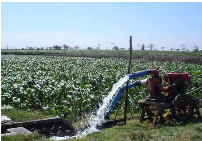
Gambar 3. Sistem pengairan dengan pompanisasi.
